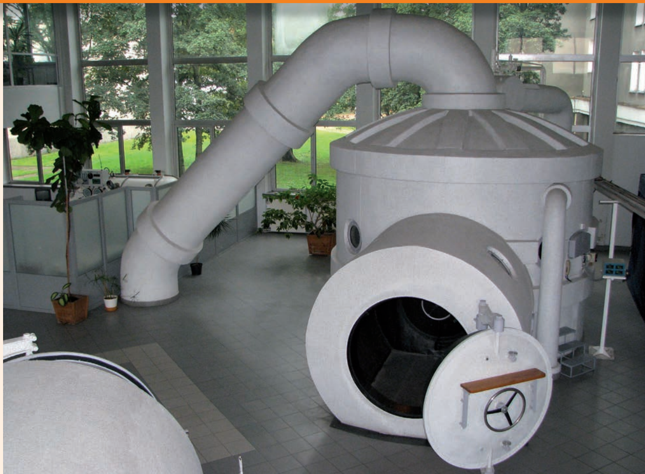
Komora niskich ciśnień i temperatur z możliwością nagłej dekompresji (Wojskowy Instytut Medycyny Lotniczej)
