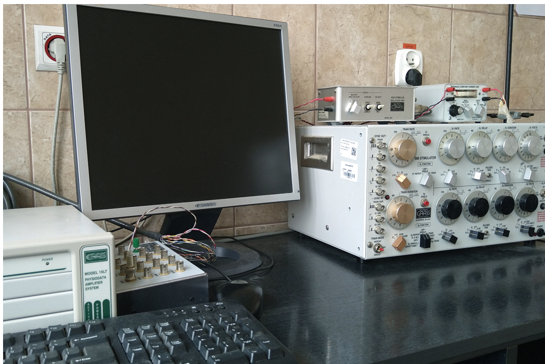
System do stymulacji struktur mózgu i rejestracji EEG u zwierząt doświadczalnych
